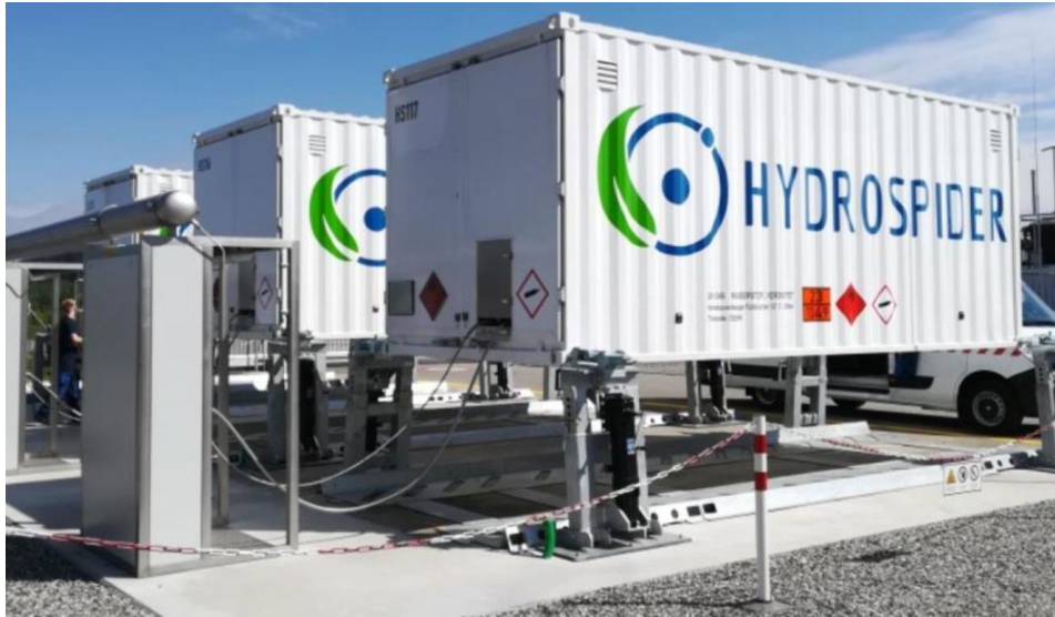
Abbildung 83: Abfüllstation mit Logistikkomponenten für die Wasserstoffproduktion und Auslieferung [85].
