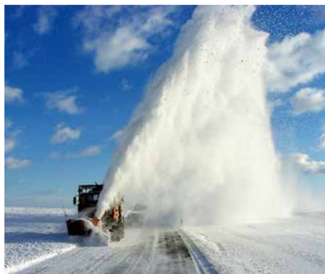
Die Schneeschleudern können bei Bedarf am Fahrzeug angebracht werden.
